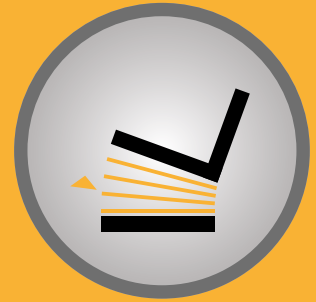
Die Sitzkantelung nach hinten ermöglicht eine Neigung des gesamten Systems um bis zu 33 bis 40 Grad
