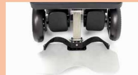
Die Beinstütze weicht automatisch federnd aus, wenn sie irgendwo anstößt, wodurch Schäden vermieden werden.
