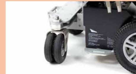
Durch die Schlepplenkung dreht der LEOflex auf der Stelle, die Zwillingräder sorgen auch bei hoher Belastung für die nötige Stabilität.
