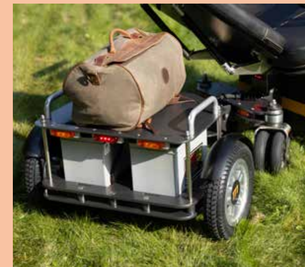
Der Anhänger ist optional erhältlich und nachrüstbar. Er ist bis 200 kg belastbar und kann z. B. für Zusatzakkus genutzt werden, um die Reichweite zu verdoppeln.
