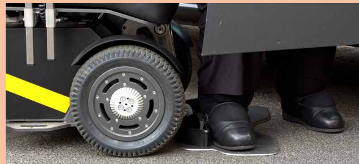
Das Fußbrett kann ebenerdig abgesenkt und für den Transfer genutzt werden.
